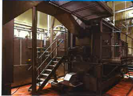
8 スプレー式湯はぎトンネル(自動)
